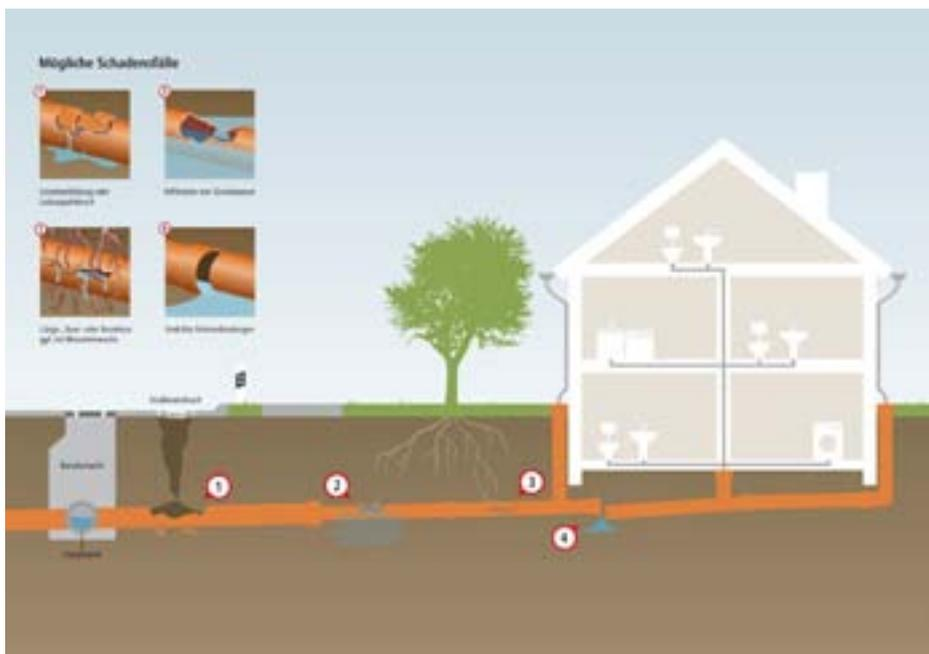
Planungsfehler, unsachgemäßer Einbau, Alterung, Verschleiß und mangelnde Wartung können zu vielfältigen Schäden führen; wie zum Beispiel Bruch, Undichtigkeit oder Wurzeleinwuchs. Potenzielle Fehlerquellen sind auch falsches Gefälle, ein fehlender Revisionssschacht oder der Anschluss von Drainagen.
