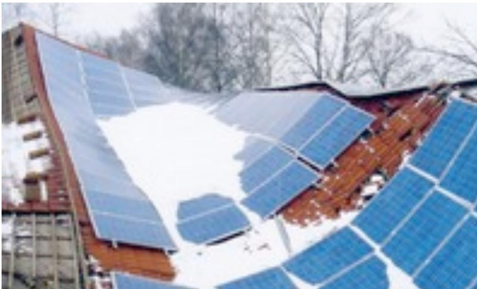
Durch Schneedruck beschädigte Photovoltaikanlage;
