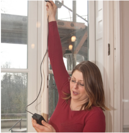
Die Feuchte in der Luft wird gemessen
