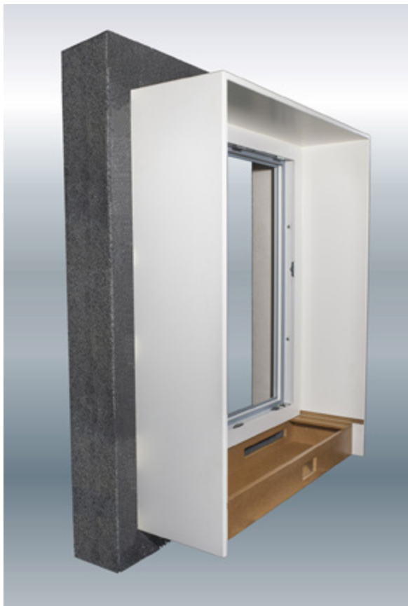
Minimalinvasive-Sanierung; alle Foto Fraunhofer
