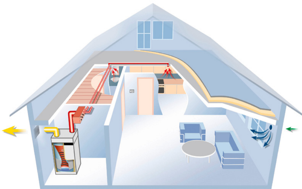
Funktionsschema Lüftungs- Wärmepumpe
