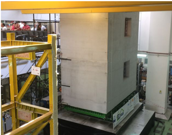
Extrem standsicher: Auf einem Rütteltisch an der Universität Neapel wurde das als Stahl-Leichtkonstruktion gebaute ELISSA Haus einem simulierten Erdbeben der Stärke 6 (Richterskala) ausgesetzt. (Foto: Knauf)
