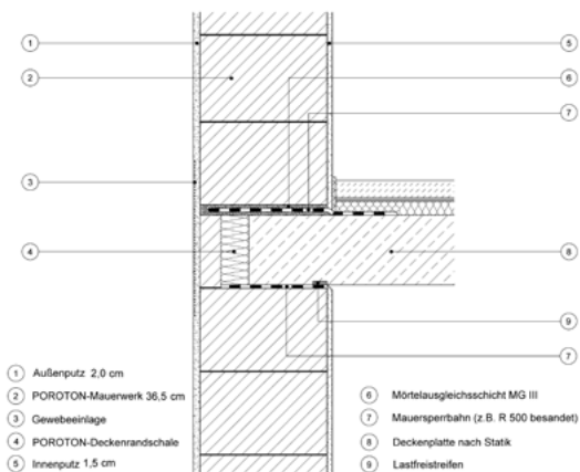
Bild 2 Die Deckenaufleger wurden mit Poroton-Deckenrandschalen wärme- und schalltechnisch optimiert
