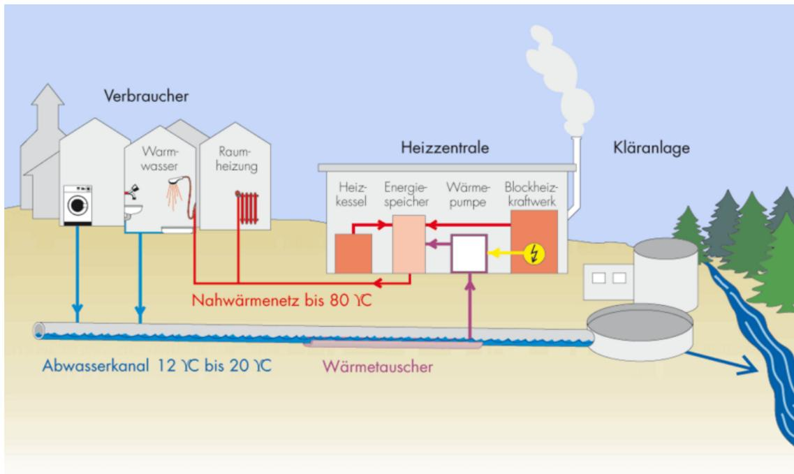
Mit Temperaturen zwischen 12 und 20 Grad Celsius ist Abwasser eine regenerative Energiequelle, die ganzjährig zur Verfügung steht. Diese Energie kann auf einfache Weise zum klimafreundlichen Heizen und Kühlen größerer Gebäude genutzt werden. Grafik: InfraWatt (Schweiz)
