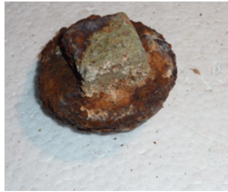
Bild 6: der „verrostete“ Eisenstopfen
