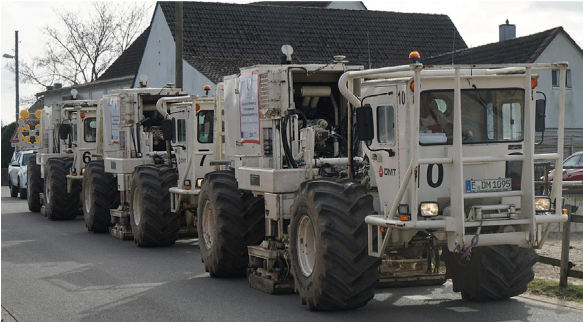
Die Vibro-Trucks verfügen über eine Rüttelplatte, die Schwingungen mit Frequenzen von einigen Hertz in den Untergrund abgeben können. © Fraunhofer IEG/Born
