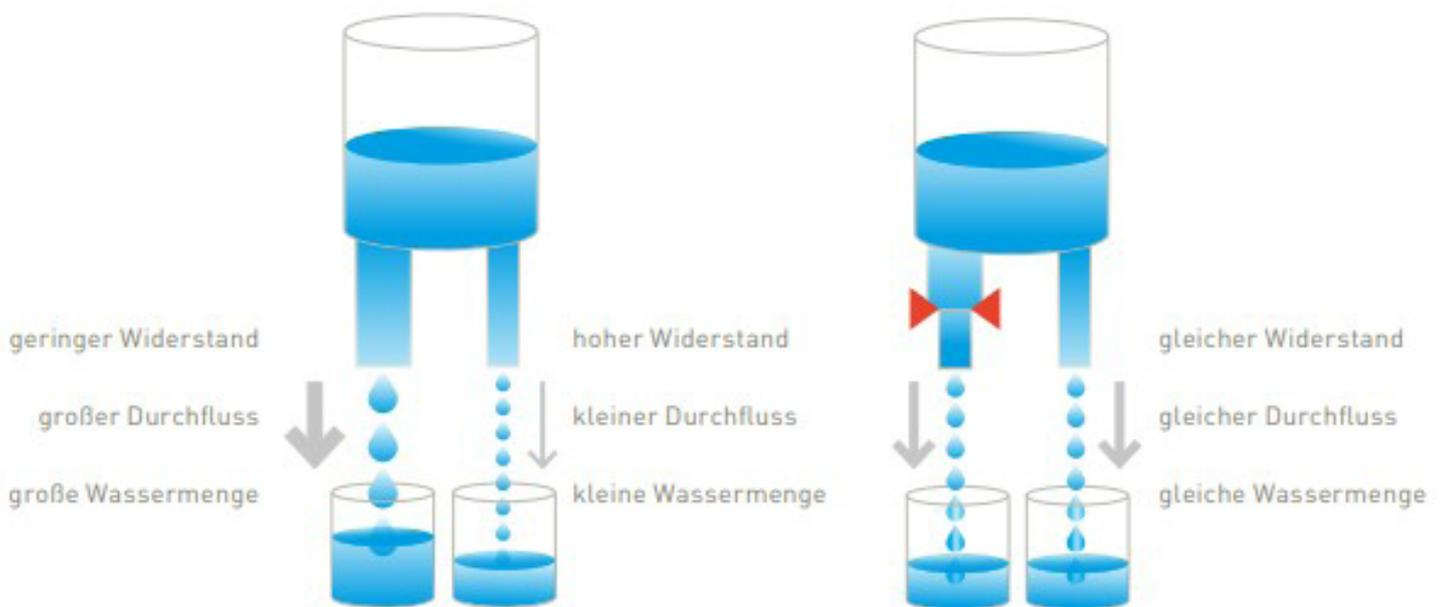
Hydraulischer Abgleich in Heizungsanlagen - Das physikalische Prinzip. Grafik: VdZ. Der Leitfaden Hydraulischer Abgleich in Heizungsanlagen steht als Download kostenlos zur Verfügung. [KLICKEN](#) Sie einfach auf die Grafik und der Leitfaden öffnet sich als PDF
