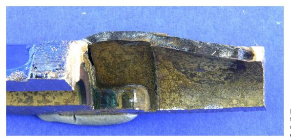
Dieses Bild vom aufgetrennten Bruchbereich zeigt die starke Verformung des Materials. www.ifs-ev.org
