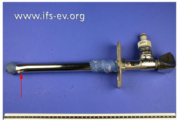
Die Armatur wird im Labor untersucht. Sie ist am hinteren Ende rissartig aufgeplatzt (Pfeil). www.ifs-ev.org
