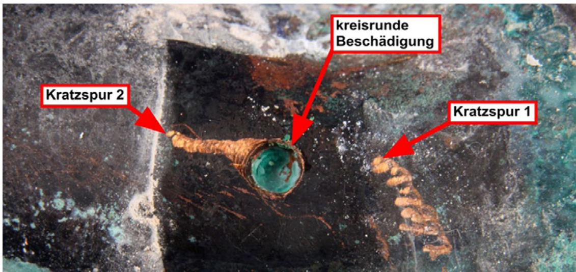
Das Werkzeug wurde zweimal angesetzt, wie die Kratzspuren zeigen. www.ifs-ev.org
