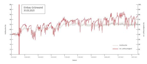
Es ergab sich ein durchschnittlicher Anstieg der relativen Luftfeuchtigkeit um 26,7 Prozentpunkte. Sowohl die relative als auch die absolute Luftfeuchtigkeit überschreiten – ohne Lüftungskonzept – die normativen Grenzwerte nach DIN EN 15251. Fotos und Grafik: Brüninghoff
