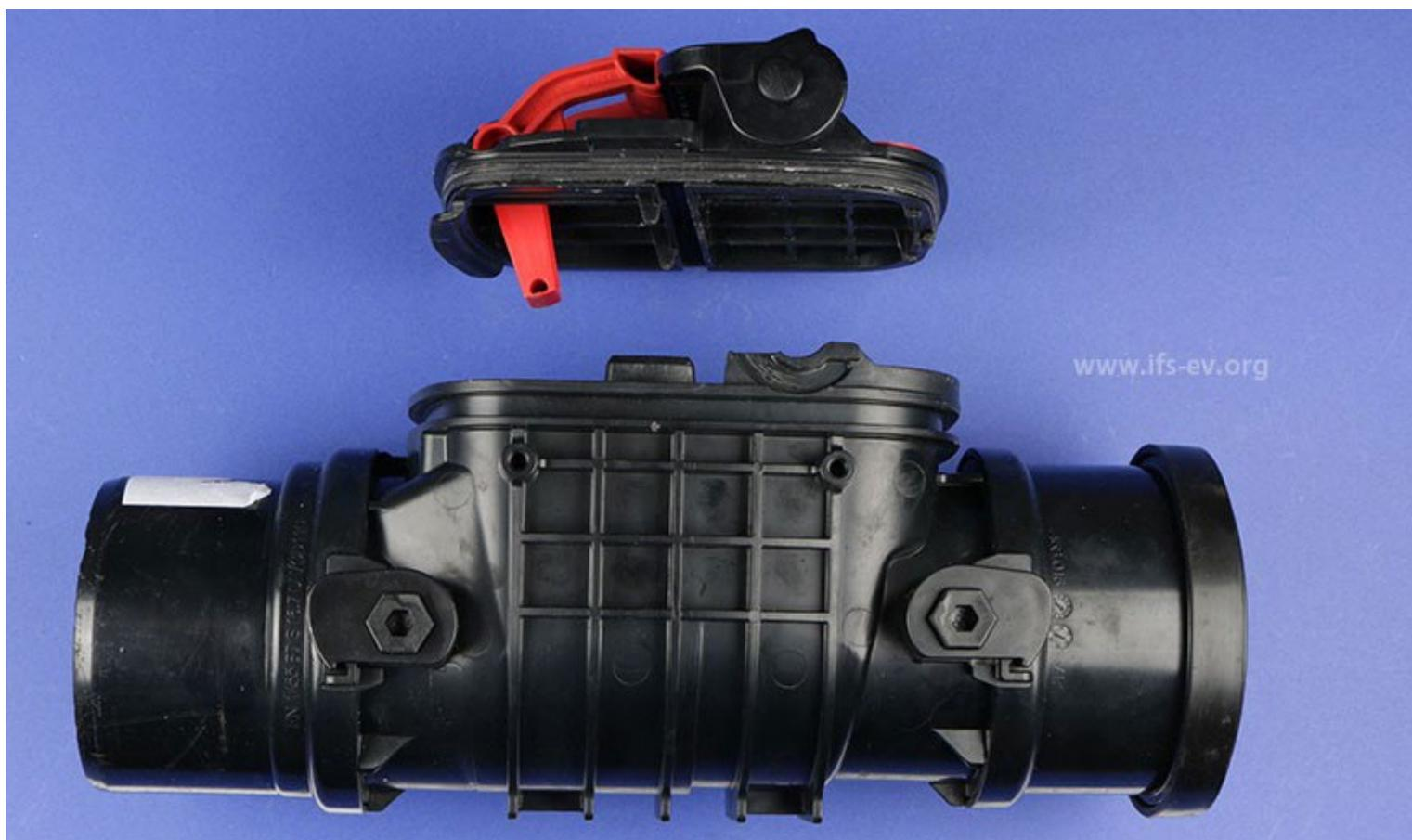
Die Rückstausicherung aus dem zweiten unten geschilderten Fall besteht aus einem Grundkörper mit zwei eingesetzten Klappen und einem Deckel mit Notverschluss-Hebel (rot). Foto: [www.ifs-ev.org](http://www.ifs-ev.org).
