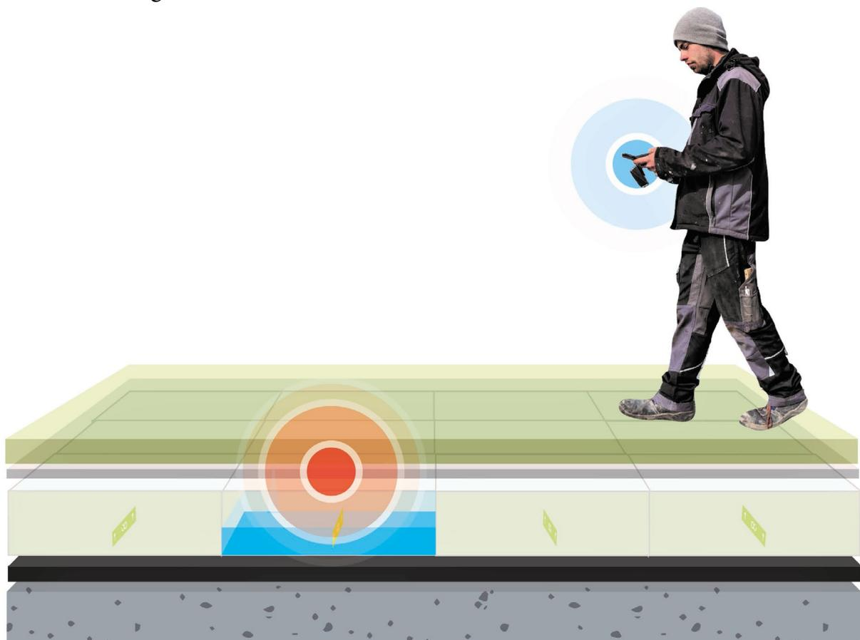
Kontrolliert werden die Nässe-Sensoren mit einem Scan-Gerät und dem Smartphone. Die HUM-ID App für iOS und Android ermöglicht eine schnelle und intuitive Kontrolle und protokolliert nasse Stellen automatisch. Alle erfassten Daten stehen den Anwender jederzeit zur Verfügung.
