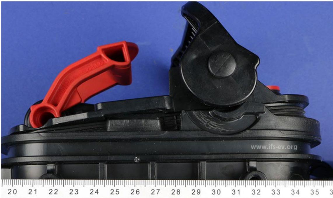
Die Detailaufnahme lässt erahnen, dass sich der Deckel schwer einsetzen lässt. Der schwarze Schnellverschlusshebel ist jedoch weder dafür vorgesehen noch geeignet, einen schwergängigen Deckel in die richtige Position zu hebeln. Foto: [www.ifs-ev.org](http://www.ifs-ev.org).
